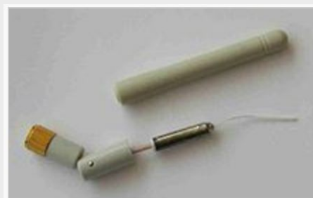
Antenne tige basique omnidirectionnelle à 2,4 GHz.
